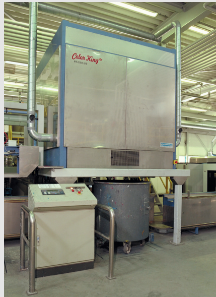
Erhöhte Aufstellung Behälterdosierung
