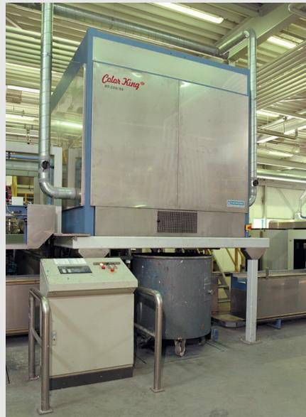
Erhöhte Aufstellung Behälterdosierung
